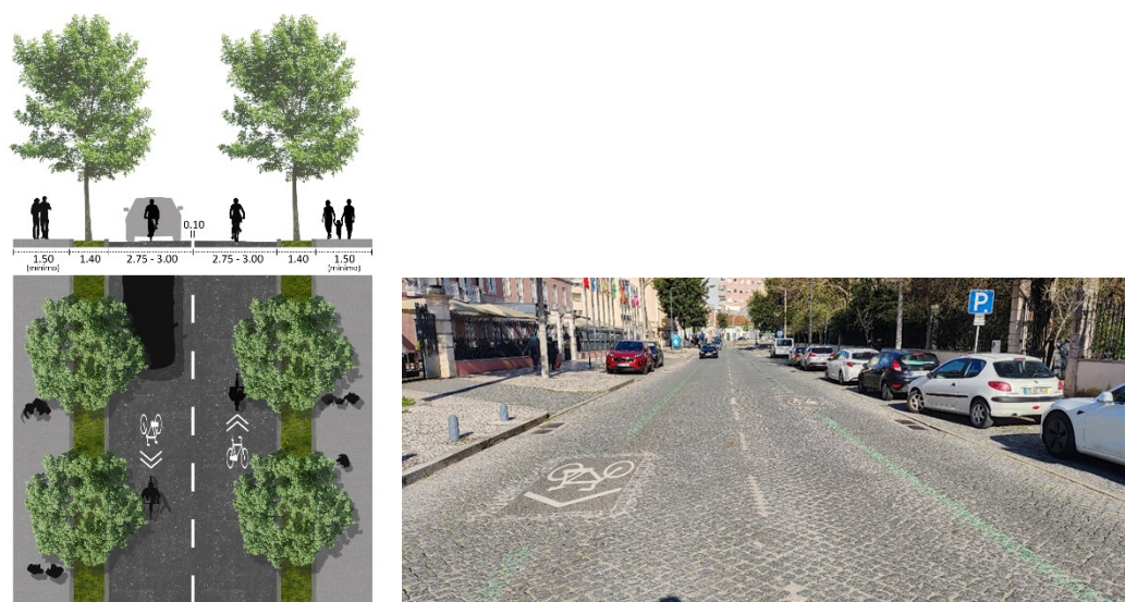
Figura 14. Perfil- tipo de canal partilhado com o automóvel e imagem de referência
