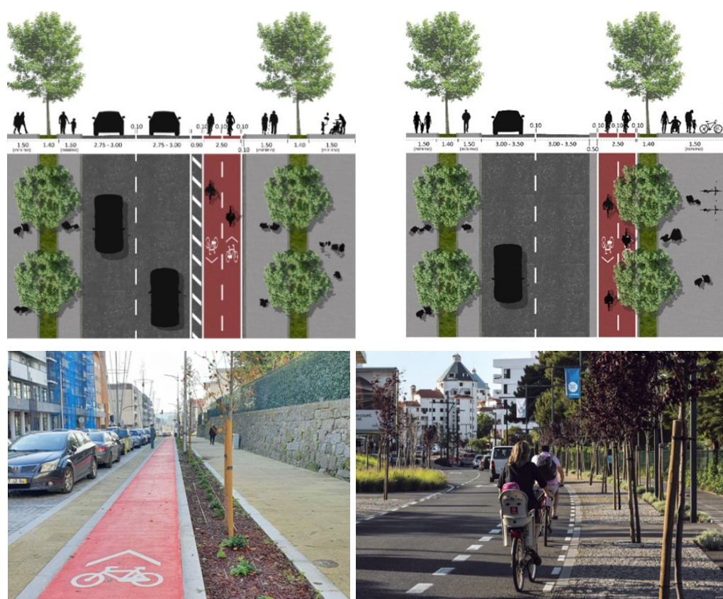
Figura 13. Perfis-tipo de canais próprios cicláveis – pista e corredor – e imagens de referência
