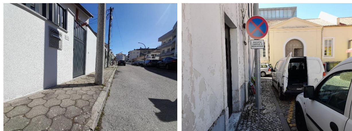
Figura 26. Exemplos associados à localização de candeeiro de iluminação pública e sinal de trânsito a obstruir o canal pedonal na área de estudo Fonte: mpt®, 2022
